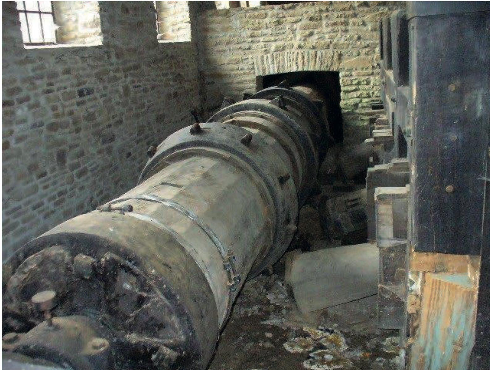
Abbildung 20: Der Stamm der über 300 Jahre alten Eiche, aus dem die neue Wasserradwelle für das Gebäude Kupferhammer hergestellt wurde. – Foto: Mühlenbau Gottfried Schumann, Mulda. Wiedergabe mit freundlicher Erlaubnis.
